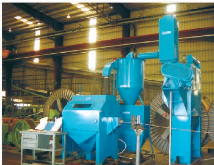
Special equipment to increase adhesion of insulation for ABC Cable Thiết bị làm tăng độ bám dính của cách điện cho cáp ABC
