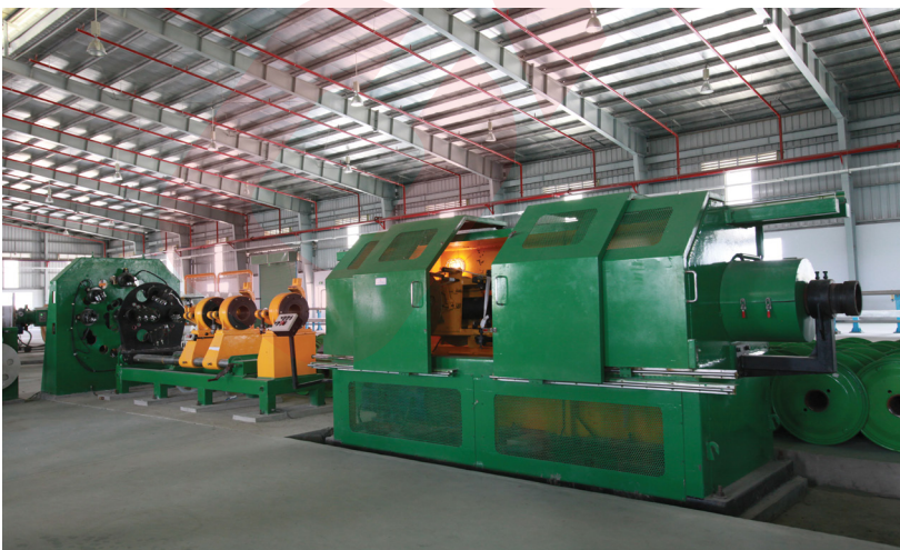
Hệ thống drum twister Drum twister system
